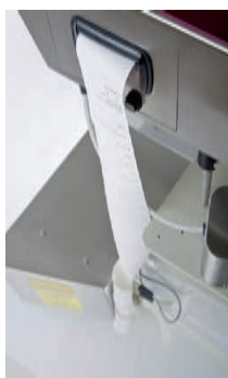
Встроенный термопринтер для распечатки результатов
