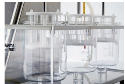
Три синхронно работающие корзинки прибора DIST 3
