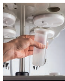
Система очистки автоматических пробоотборников
