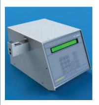
Автоматический тестер твердости таблеток TH 1050M
