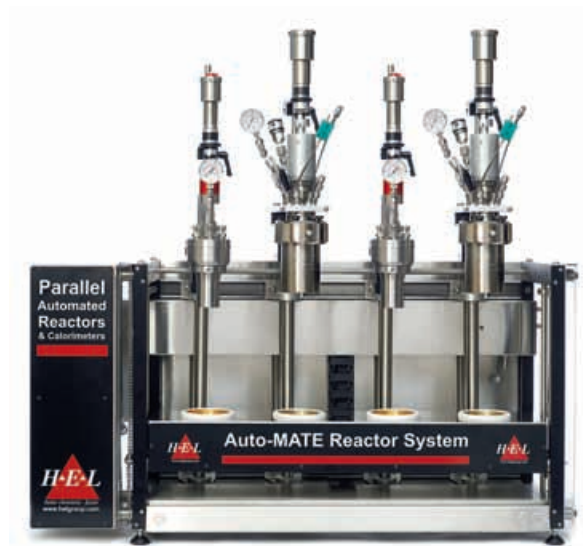
100 и 300 мл взаимозаменяемые реакторы с роторными мешалками
