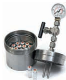
Реактор CAT 18 с 18×1 мл пробиками для работы под давлением
