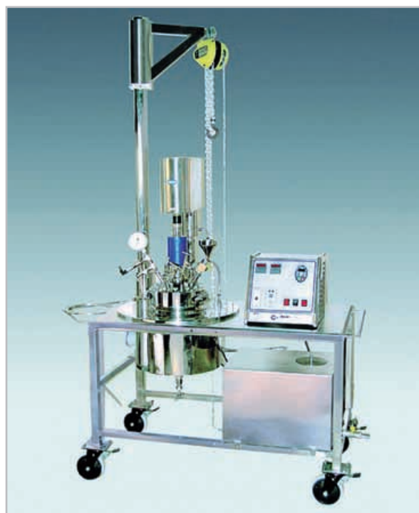
20 л реактор на 100 атм и 350 °С с электрическим нагревом, подъемником и тележкой
