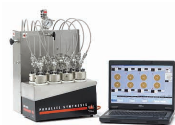
8x75 мл реакторы высокого давления с гребенкой для подачи газа и погружными механическими мешалками
