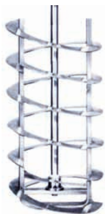
Геликоидная мешалка для систем с высокой вязкостью
