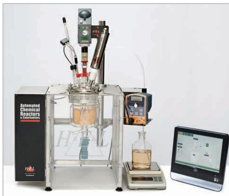
Настольный реактор с планшетным компьютером для управления и непрерывной записи данных
