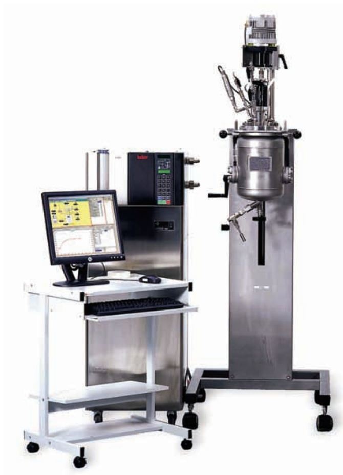
20 л реактор с масляной рубашкой и гидравлическим подъемником
