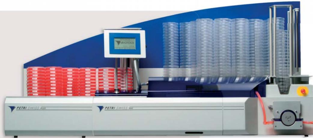
Автоматическая разливка среды, предварительно приготовленной в автоматической средоварке ProfiClave и поддерживаемой при постоянной температуре.
