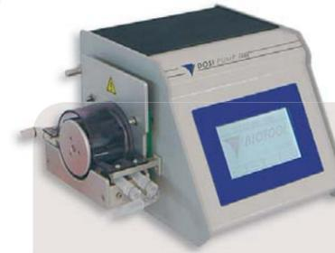
Специальный дозирующий насос DosiPump используют для добавления в приготовленные питательные среды термолabileных добавок (кровь - для приготовления кровяного агара, витамины, НАД, Гемин- для культивирования гемофильных бактерий и т.п..)
