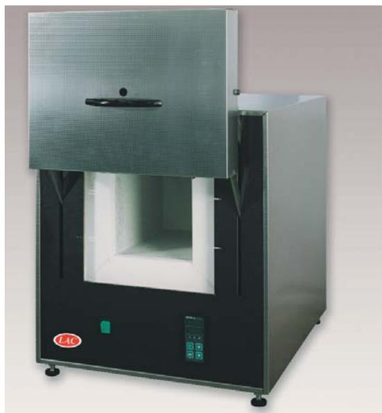
Корпус из нерж. стали, минимальный нагрев которого достигается за счёт двухслойного кожуха, охлаждаемого с помощью принудительной воздушной циркуляции. Внутренняя камера (муфель) - керамическая. Многослойная волокнистая керамическая безасбестовая термоизоляция. Спираль нагревателя размещена вокруг наружной поверхности муфеля. Обзорное отверстие в дверце. Труба для отвода газов в задней стене. Автоматическое отключение питания при открывании дверцы.
