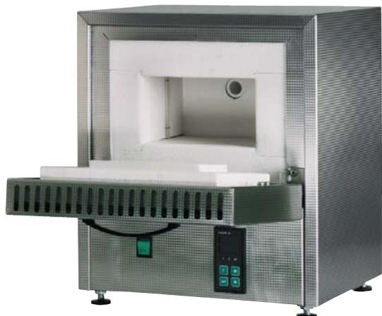
Корпус из нерж. стали. Внутренняя камера и поверхность дверцы из волокнистого термостойкого материала. Труба для отвода газов в задней стене. Автоматическое отключение питания при открывании дверцы. Цифровое программное управление в стандартной версии (программируемая скорость нагрева, выдержка при заданной температуре, скорость остывания).
